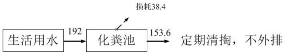
图 2.2-1 项目水量平衡图单位：m 3 /a
