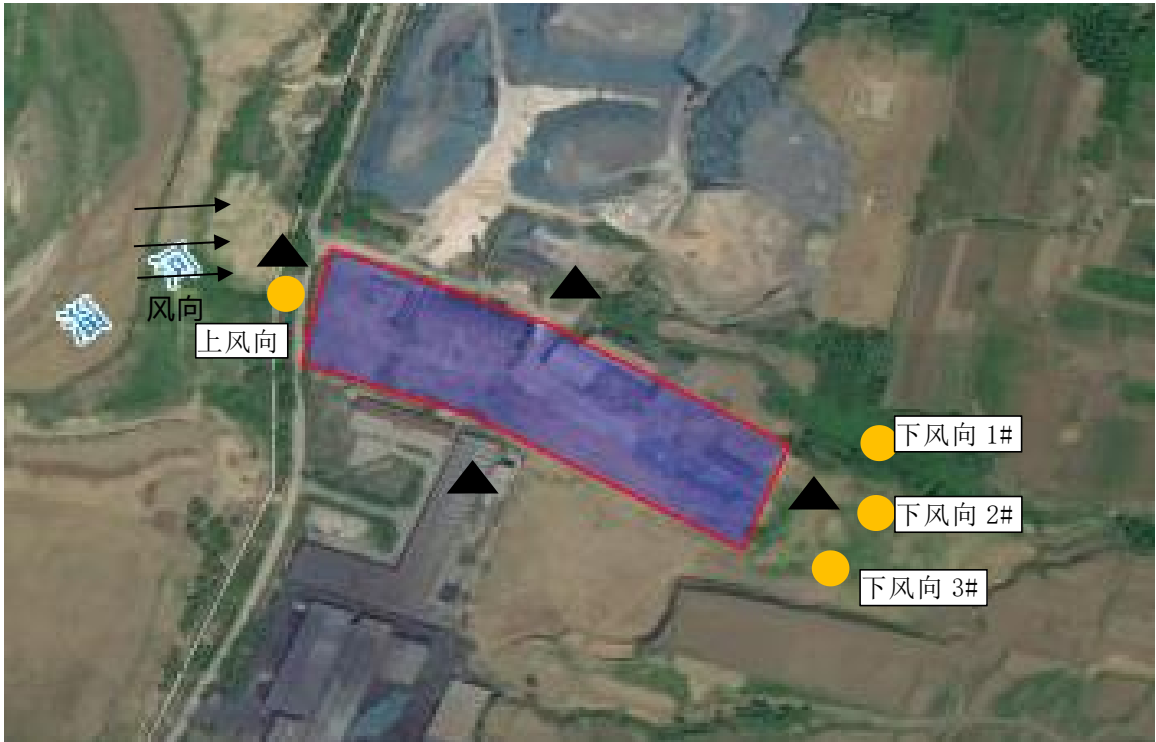
图6-1废气和噪声检测点位图
