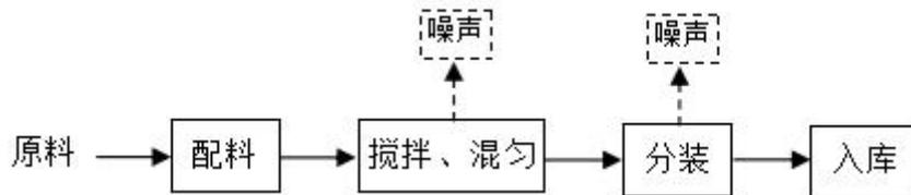
图 2-6 项目液态有机肥生产工艺及产污环节图
