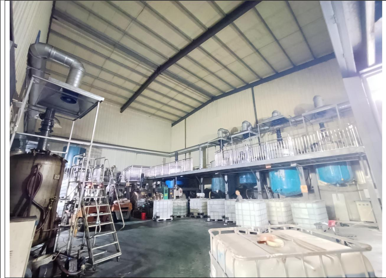
液体微生物菌肥及液体有机肥发酵车间废气均安装集气罩收集
