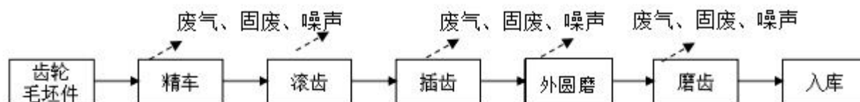
图2.3-1 工程机械齿轮配件生产工艺流程图
