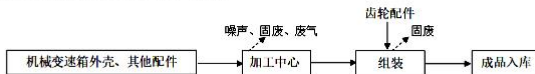
图2.3-2 工程机械变速箱生产工艺流程图
