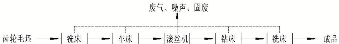
图 2.3-1 生产工艺流程及产污环节示意图
