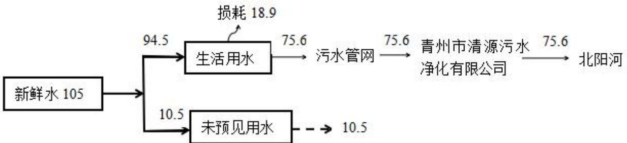
图2.2-1 项目水平衡图 单位:  $\text{m}^3/\text{a}$
