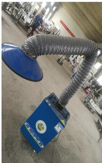
移动式焊接烟尘净化器
