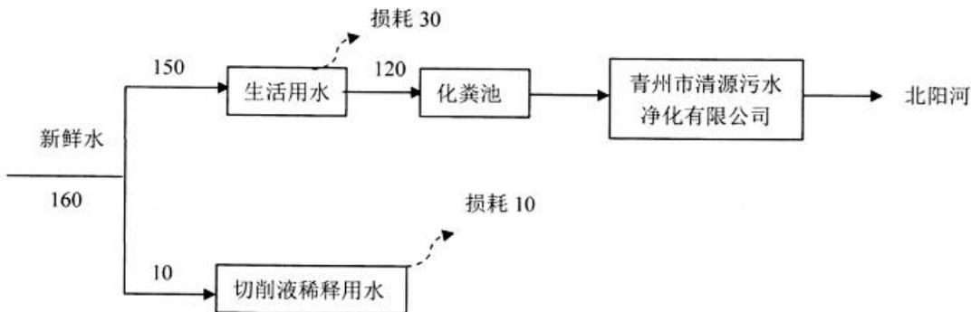
图 2.2-2 项目水量平衡图 单位：m<sup>3</sup>/a
