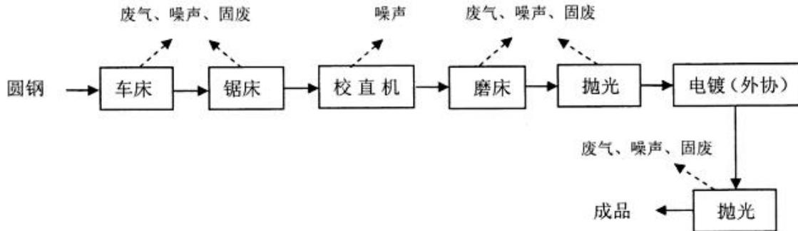
图 2.3-1 生产工艺流程及产污环节示意图
