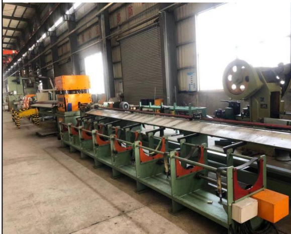
拉拔机生产线
