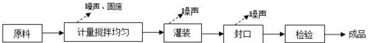
图 2.3-4 水溶肥（液体）生产工艺流程及产污环节图
