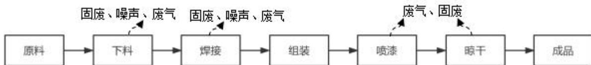
图 2.3-1 专用设备工艺流程及产污环节示意图
