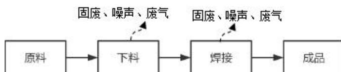
图 1 配件生产工艺流程及产污环节示意图
