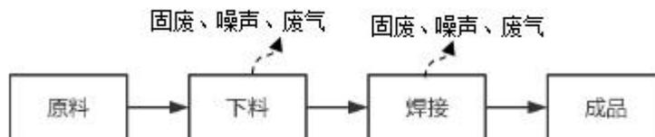
图 2.3-2 专用设备配件工艺流程及产污环节示意图
