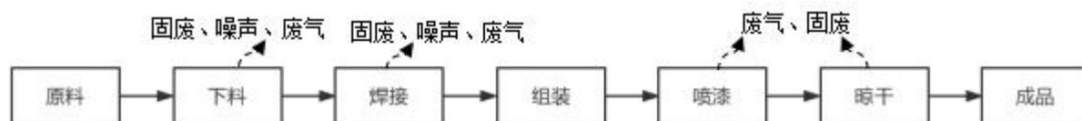
图 1 专用设备生产工艺流程及产污环节示意图
